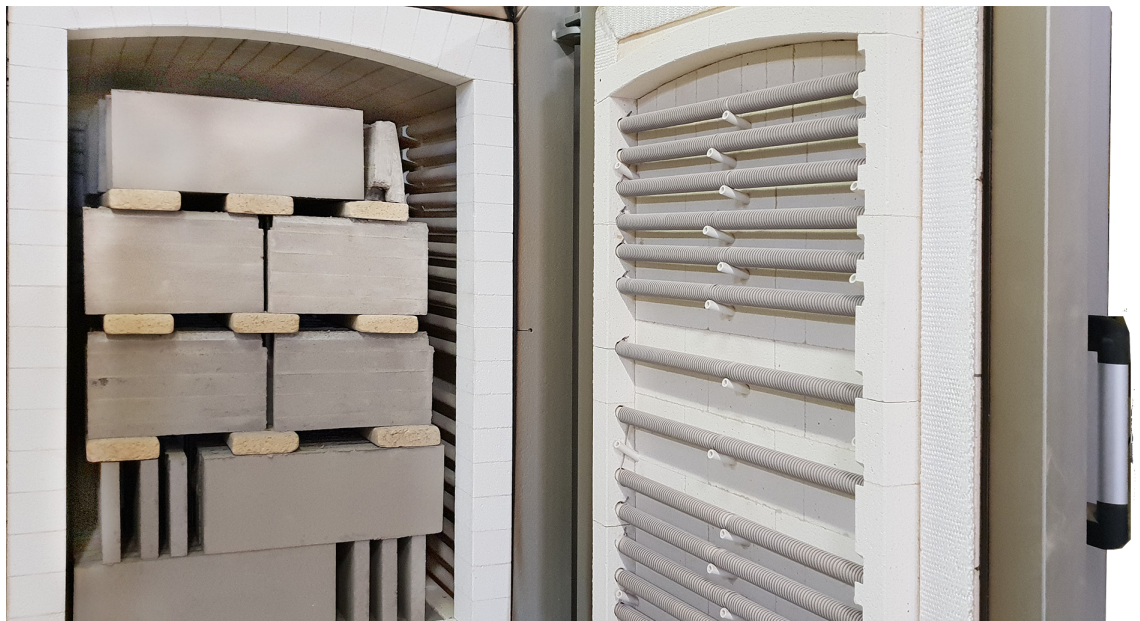
Oben: Eingesetzter Elektro Ofen - vor dem Brennen der Steine
