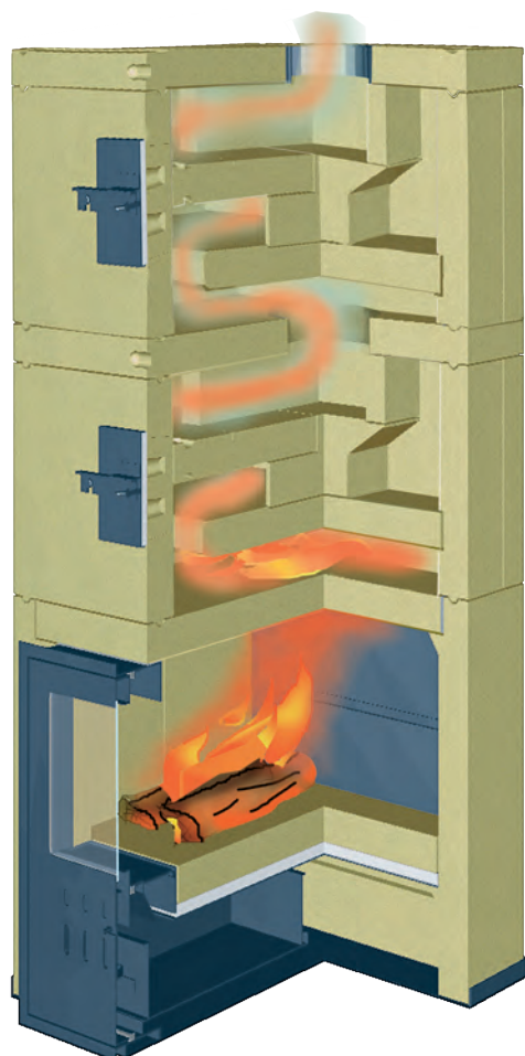
Schnitt mit Funktionsschema vom Abbrand durch Schamottebausatz Cubolino Comfort
